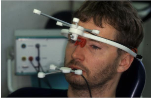
Abb. 4: Jaw-Motion-Analyzer (Fa. Zebris)
